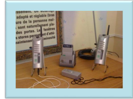
Un système de signalisation sans fils a flash et vibration pour prévenir lorsque le téléphone sonne, bébé pleure, la sonnette retentit ou un incendie se déclenche.
